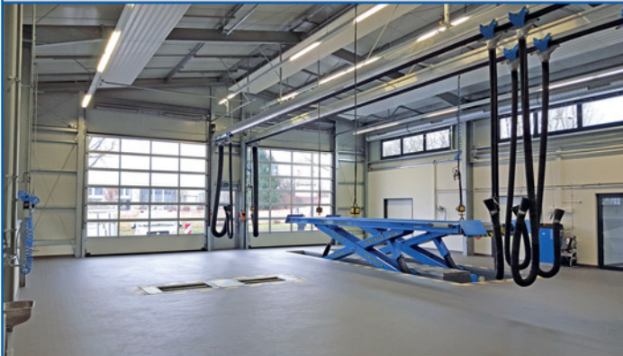
Innenansicht mit Hebebühne und Bremsenprüfstand
