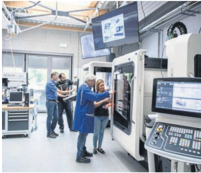
Ausbildung an der CNC-Fräsmaschine „DMU 50“: Diese ist das Herzstück im Fachbereich Metall-, CAD- und CNC-Technik.
